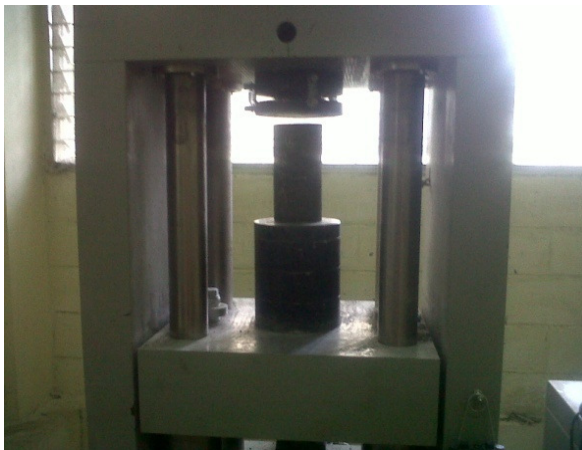
Gambar 4. Pengujian kuat tekan beton
