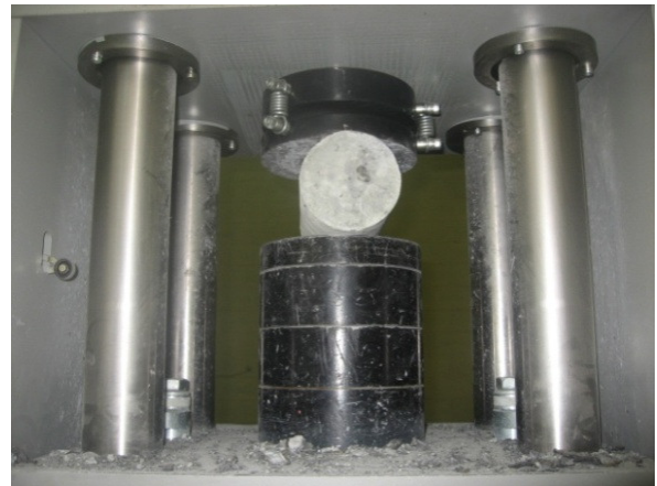
Gambar 5. Pengujian kuat tarik belah beton
