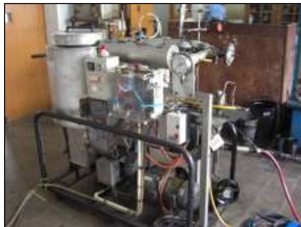
Gambar 5. Alat untuk Pembuatan Foam Bitumen di Laboratorium
