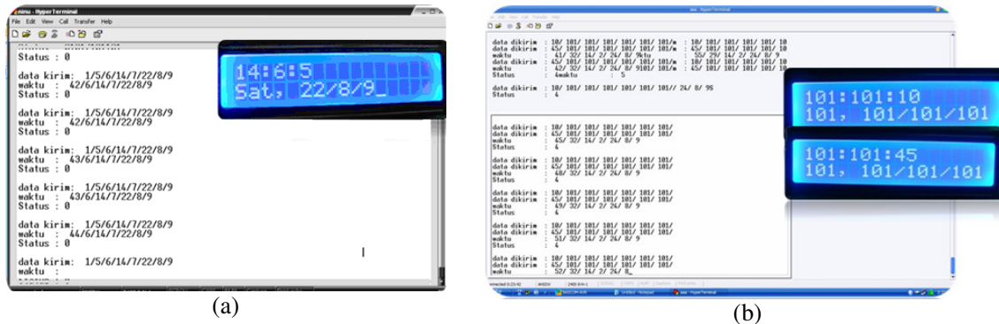
Gambar 8(a). Tampilan Remote control untuk Setting RTC ; (b) Tampilan Hyperterminal dan LCD untuk Setting Switch
