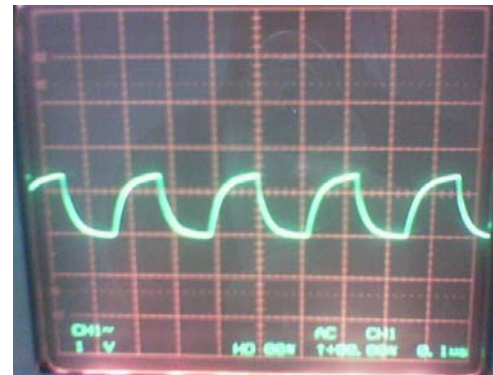
Gambar 14. Hasil Pengukuran Prescaler
