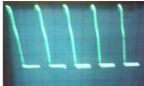
Gambar 4.7 Gelombang Keluaran Semikonverter Satu Fasa dengan Sudut Penyalaan 90°
