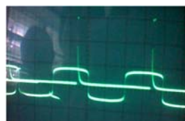
Gambar 4 Gelombang Output IC TCA 785 dengan Sudut Penyalaan 180° (kaki 5)
