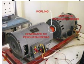
Gambar 3.5 Motor DC penguatan Terpisah yang dikopel dengan generator.
