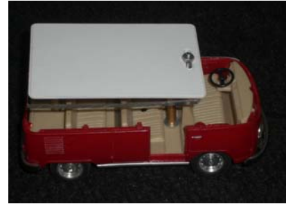
Gambar 17. Posisi kartu RFID pada miniatur kendaraan
