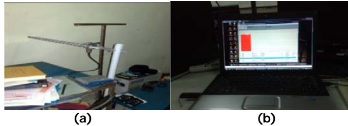
Gambar 15. Pengukuran Aplikasi Antena pada notebook (a) antenna yagi yang diukur (b) notebook yang berfungsi sebagai penerima
