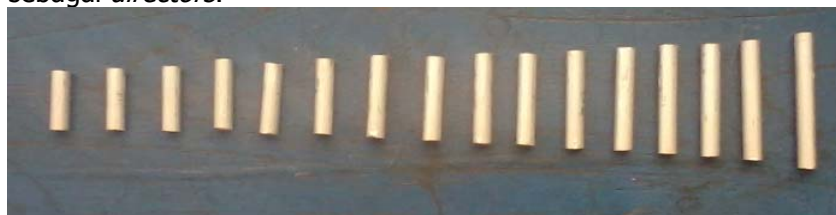
Gambar 2. Potongan Aluminium Sebagai Elemen Antena Yagi 15 Elemen
