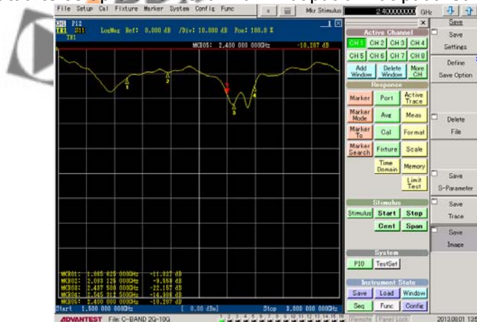
Gambar 9. Hasil Pengukuran Return Loss
