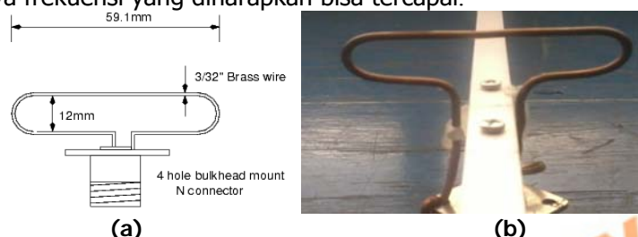
Gambar 5. Skema pemasangan antena dipole (a) gambar skema ukurannya (b) antena folded dipole yang sudah tersambung pada N konektor
