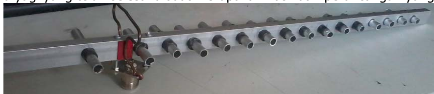
Gambar 7. Hasil Rancangan Antena yagi 2,4 GHz
