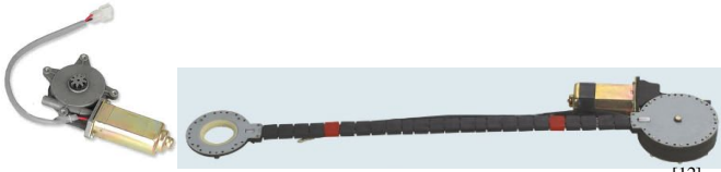
Gambar 9. Motor power windows sebagai aktuator UGV [12]
