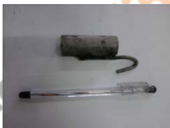
Gambar 6. Logam berkait penghubung Motor DC dengan Antena
