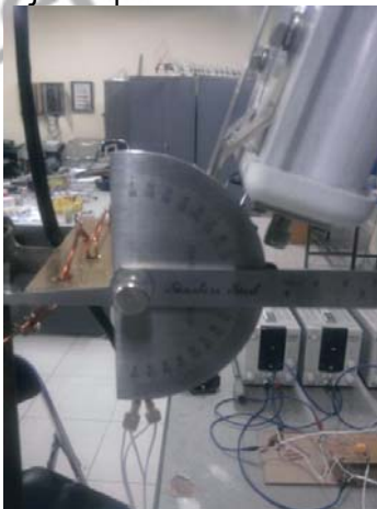
Gambar 17. Pengujian remote tilting antenna berdasarkan tingkat kemiringan
