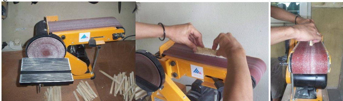
Gambar. 2. mesin disc & belt sander yang digunakan pada eksperimen awal penyerutan bonggol jagung.
