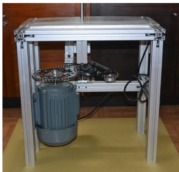
Gambar. 10. Alat serut dengan sistem penggerak menggunakan rantai..
