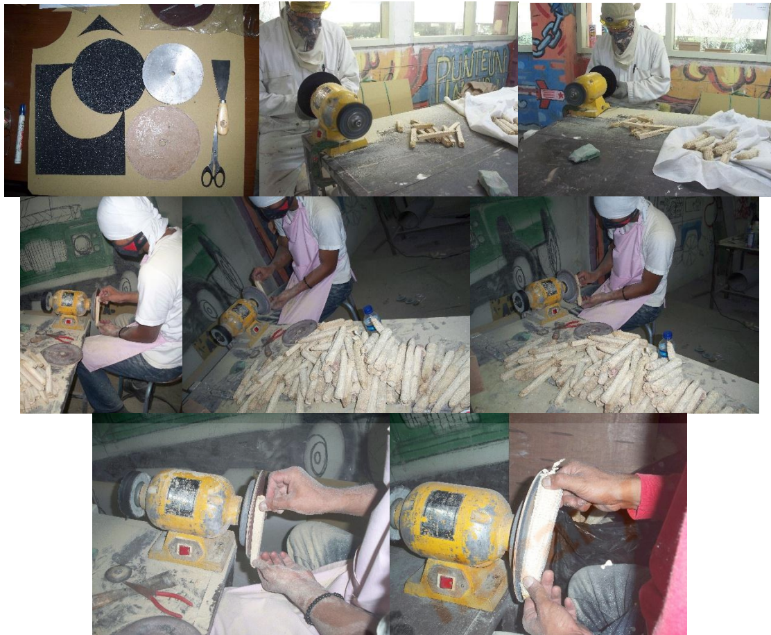
Gambar. 4. Eksperimen penyerutan bonggol jagung dengan menekan bonggol jagung pada modifikasi mesin grinda.
