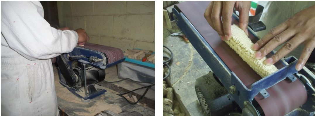
Gambar. 3. Eksperimen penyerutan bonggol jagung dengan menekankan bonggol jagung pada belt sander.
