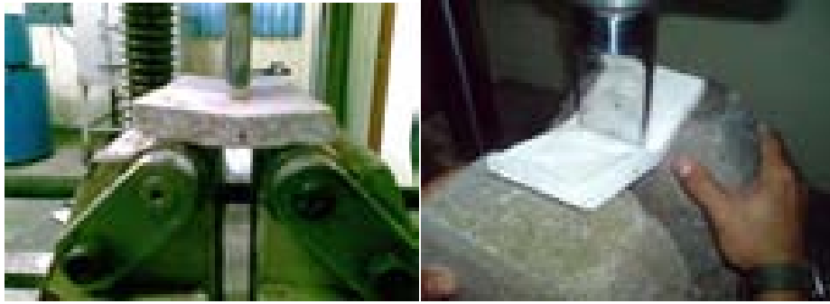
Gambar 2.19 Pengujian tekuk pada spesimen papan serat [13]
