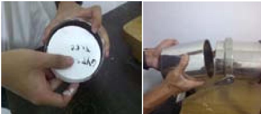
Gambar 4.7. Spesimen dimasukkan dalam kepala tabung impedansi
