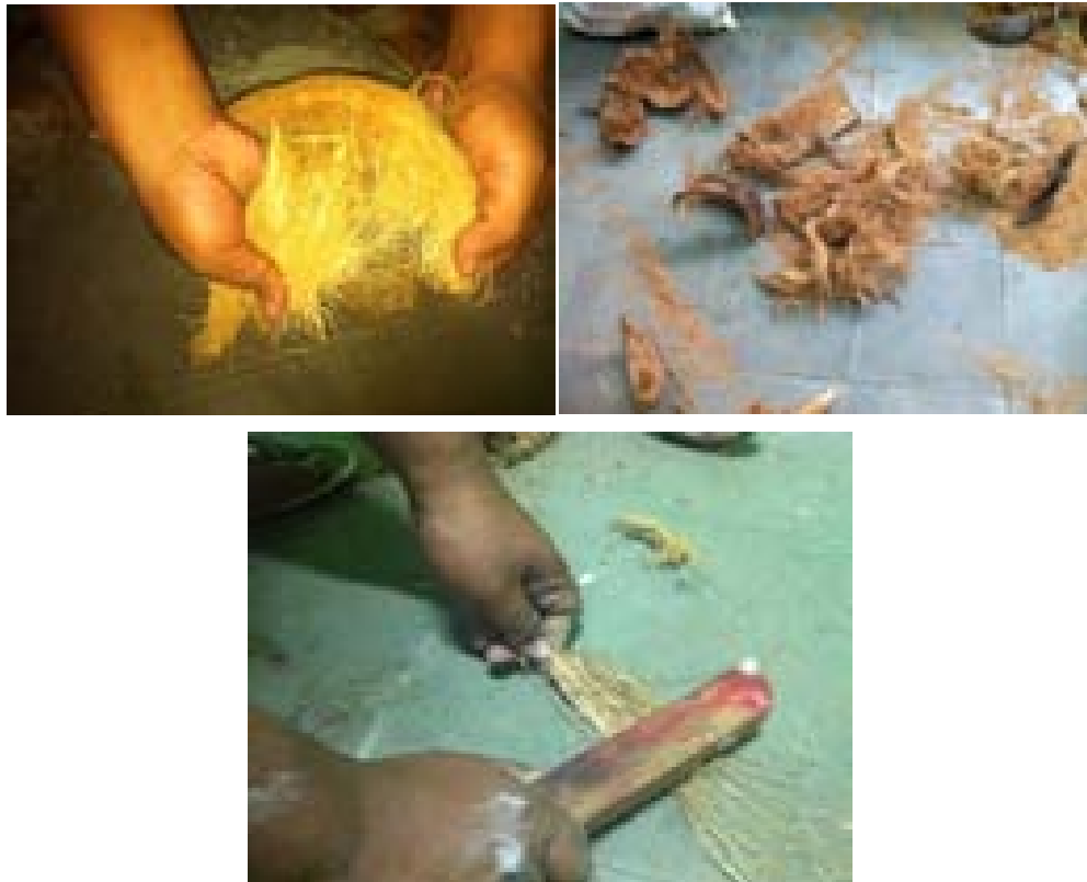
Gambar 3.9. Pengupasan Serat Kelapa
