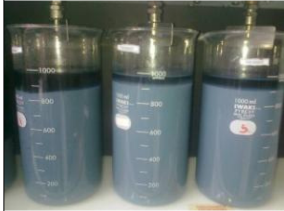
Gambar 3. Jarrest dengan Koagulan Alumunium sulfat ( \text{Al}_2(\text{SO}_4)_3 \cdot 14\text{H}_2\text{O} ) (dari Kiri ke Kanan Dosis 12.000, 6.000, dan 3.000 ppm)
