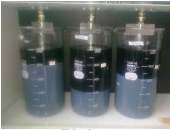
Gambar 4. Jarrest dengan Koagulan Poly Aluminium Chloride (PAC) (dari Kiri ke Kanan Dosis 12.000, 6.000, dan 3.000 ppm)
