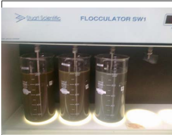
Gambar 2. Jarrest dengan Koagulan Besi (III) Clorida ( \text{FeCl}_3 ) (dari Kiri ke Kanan Dosis 12.000, 6.000, dan 3.000 ppm)
