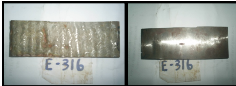
Gambar 8. Bentuk spesimen cladding dan bagian yang tidak di cladding setelah di bersihkan
