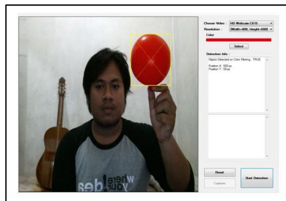
Gambar 11. hasil deteksi blob pada ruang warna RGB
