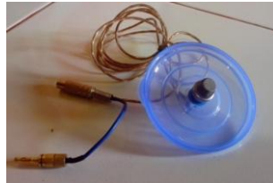
Gambar 19. Sensor MQ5 yang terhubung kabel konektor
