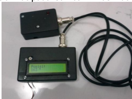
Gambar 12. Modul Kompas Digital yang Telah Diimplementasikan dengan Microcontroller AT89S52 dan LCD
