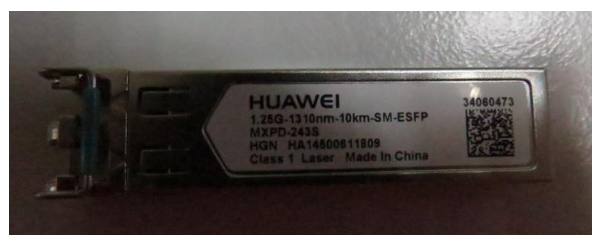
Gambar 13. SFP yang digunakan dengan standar 1000base-SX
