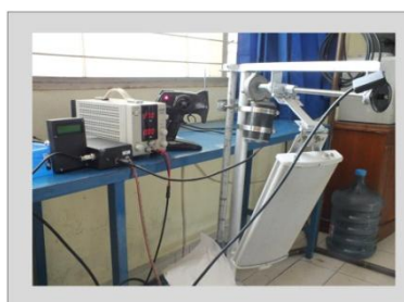
Gambar 12. Realisasi remote tilting antenna secara vertikal
