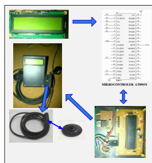
Gambar 9. Rangkaian aplikasi Modul Sensor Optocoupler dengan Mikrokontroler AT89S52
