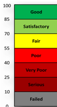
Gambar 3. Hubungan nilai PCI dan kondisi perkerasan (Sumber: ASTM D 5340-12, 2012)
